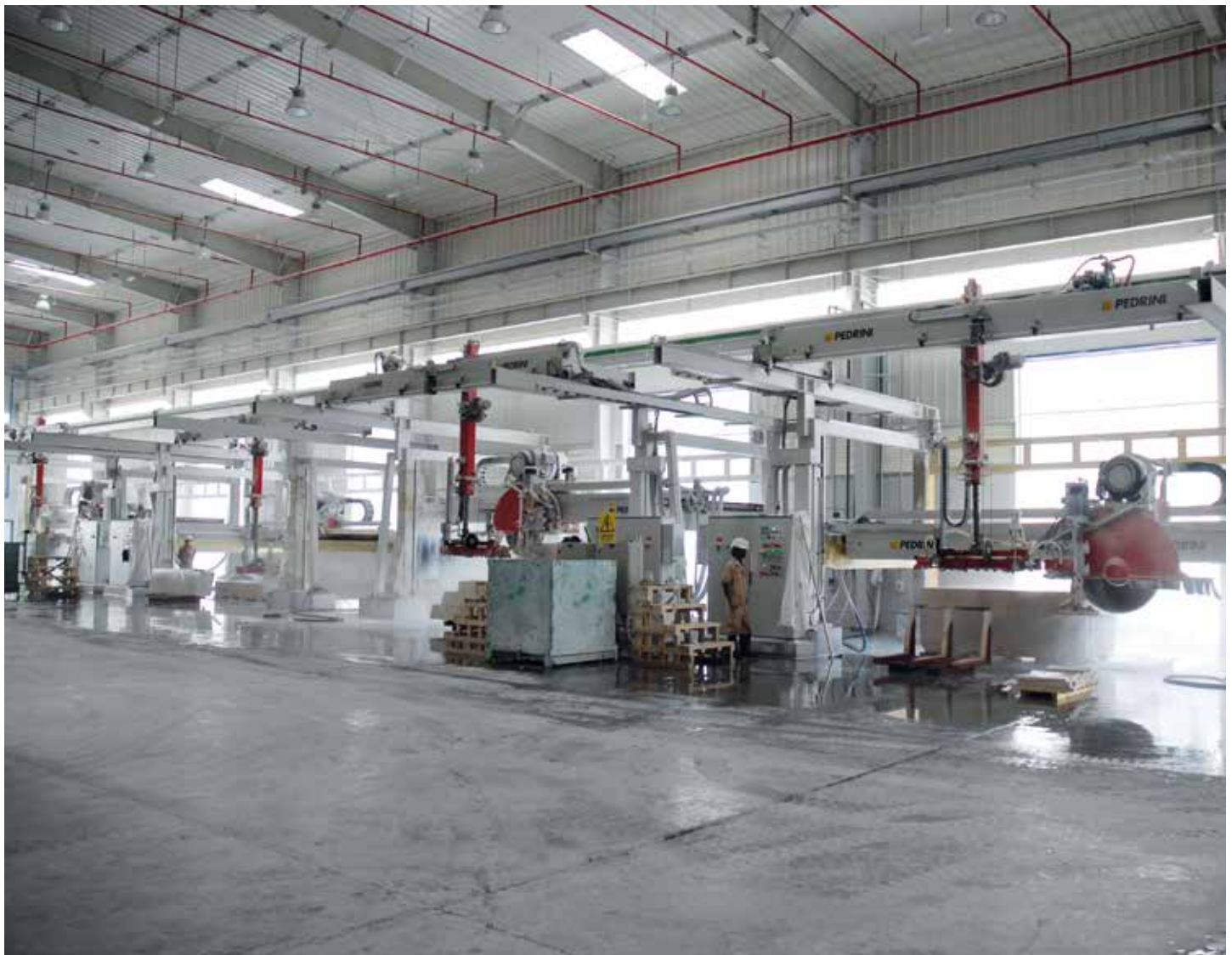
• Tagliablocchi con scaricatore automatico - Vista frontale Block cutter with automatic unloader - Frontal view
