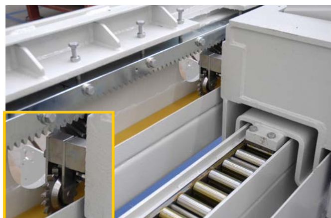
Rulli temprati con dettaglio lubrificazione a olio Hardened rollers and detail on oil lubrication
