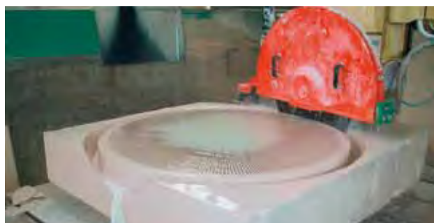
Produzione di elementi rotondi / Round elements manufacturing
