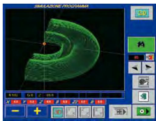
Simulazione di profilo da ottenere con fresa a candela Simulation of a profile to be obtained by shaping tool
