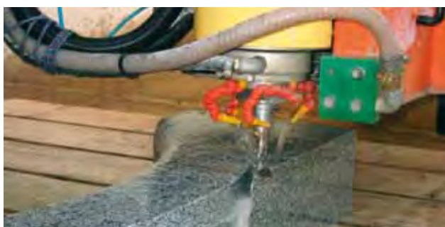
Sagomatura con elettromandrino / Shaping with electro spindle
