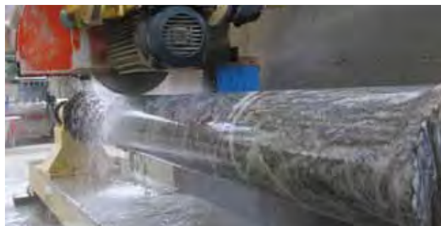
Finitura al tornio con "spatolamento" / "Spatula" finish at the lathe
